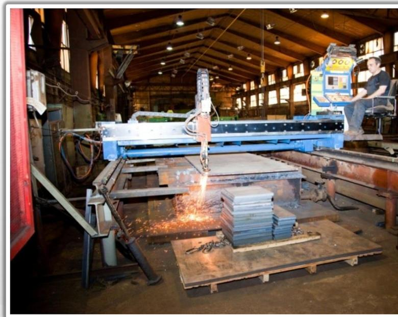
Машина термической резки
