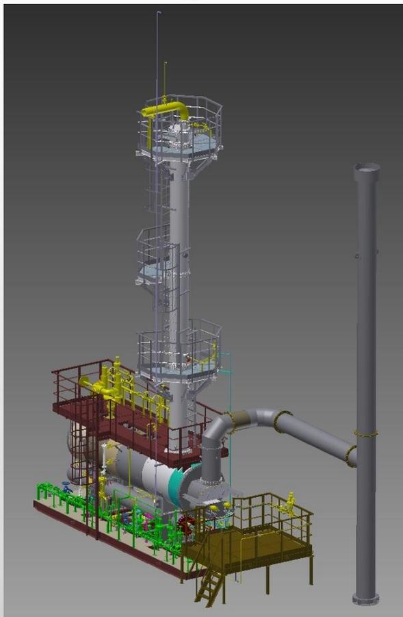
Блок огневой регенерации метанола (в дальнейшем блок), предназначен для регенерации насыщенного 35% метанола до концентрации 90%.
