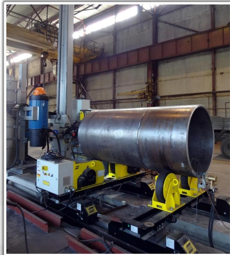
Сварочный комплекс ESAB CaB 300C
